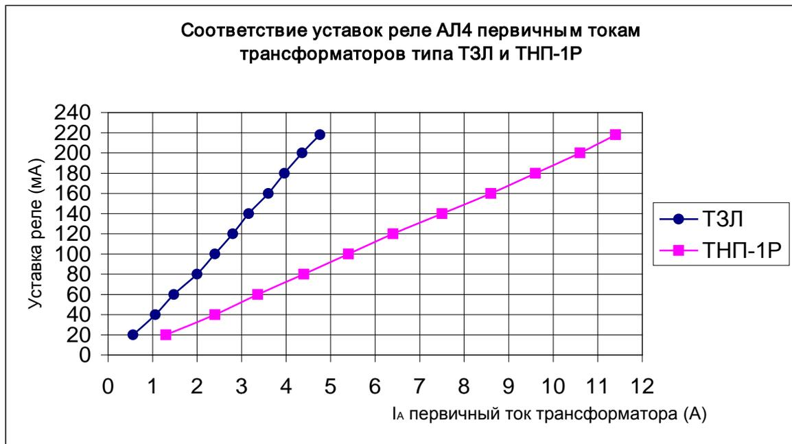
**Рисунок 3** – Типовая зависимость тока уставки от первичного тока трансформатора
